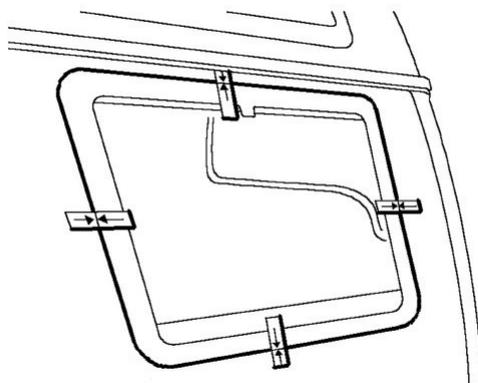
4. Nettoyez soigneusement la surface de montage de la fenêtre coulissante Explore Glazing ou de la fenêtre gullwing et la carrosserie de votre véhicule avec de l'alcool.
